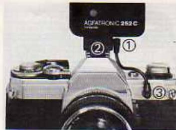
**Anschluß an Kameras mit Kabelkontakt:**
