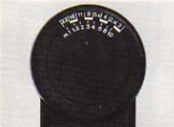
**2. Ohne Computer:** Beim Blitzen ohne Computer muß die Blende verändert werden. Blende ermitteln (s. S. 16/18), an der Kamera jedoch nächstkleinere Blendenzahl einstellen (z.B. 21 DIN, 3 m = Blende 8, nächstkleinere Blendenzahl = 5,6).
