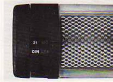
Die Belichtungsregelung erfolgt jetzt, je nach Aufnahme-Entfernung, durch die entsprechende Kamera-Blende. Filmempfindlichkeit am Blitzgerät einstellen (s. Seite 8).
