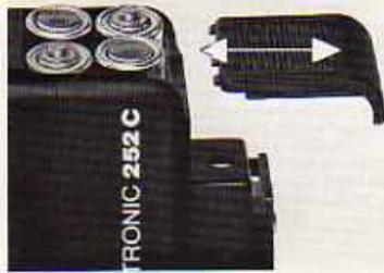
**Batterien einlegen:** Batteriedeckel abziehen. 4 Mignon-Zellen 1,5 V (z.B. Varta 4006, Mallory MN 1500, UCAR E 91) einlegen (+/- Pol-Markierung im Batteriefach beachten). Batteriedeckel wieder aufschieben.
