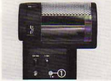
**Blitzen ohne Computer:** Bei Aufnahmen außerhalb des automatischen Aufnahme-Bereichs (z.B. bei 9 m) bzw. bei Kameras ohne abschaltbare Blitzautomatik Computer abschalten: Rote Taste ① ganz nach rechts schieben (Computer-Taste springt heraus) und zum Einschalten wieder ganz nach links schieben.
