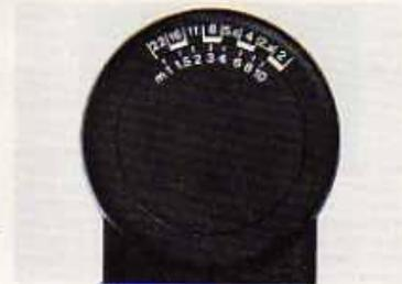
Über der Aufnahme-Entfernung an der Seite des Gerätes (z.B. 9 m) ist nun die erforderliche Kamera-Blende (z.B. 2,8) abzulesen. Diese Blende ist auf die Kamera zu übertragen.
